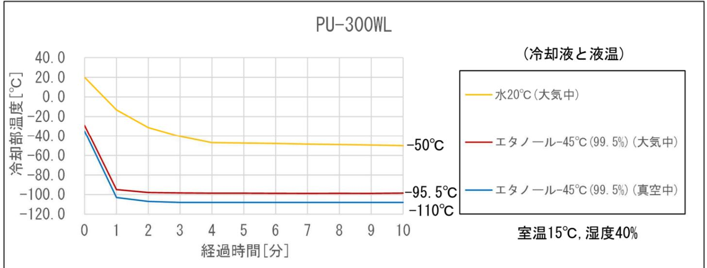
冷却能力特性(経過時間に対する温度変化)
