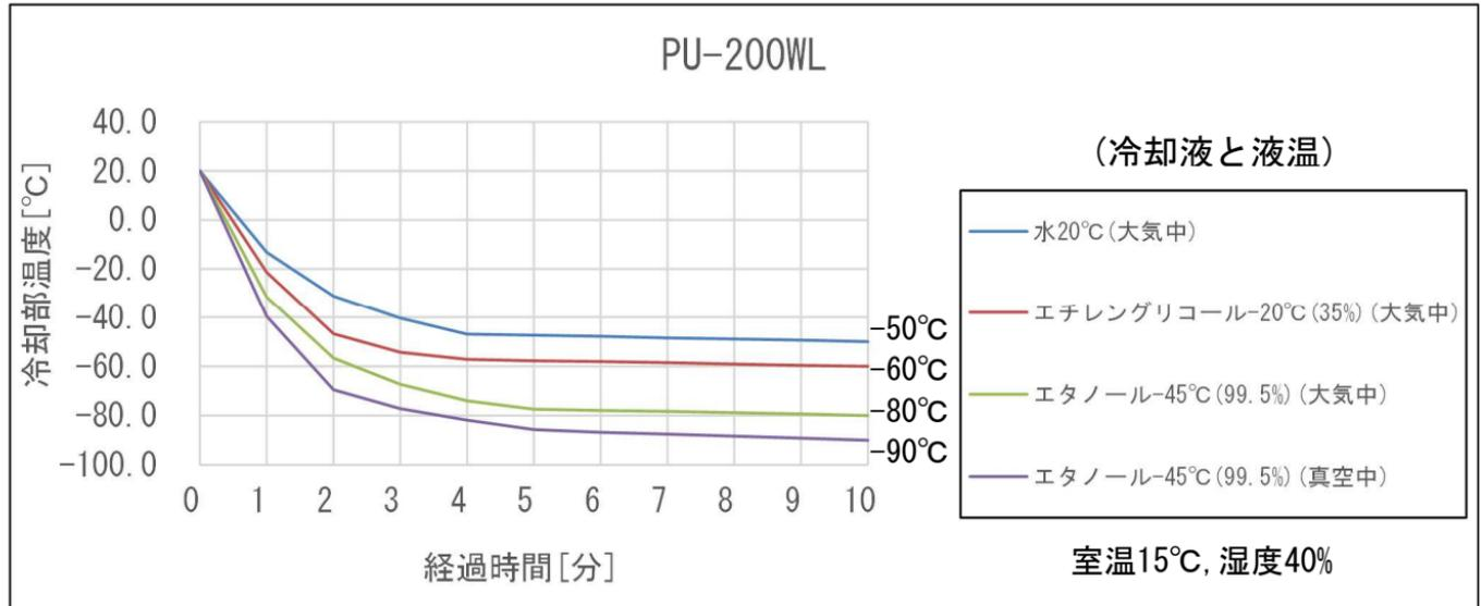
冷却能力特性 (経過時間に対する温度変化)
